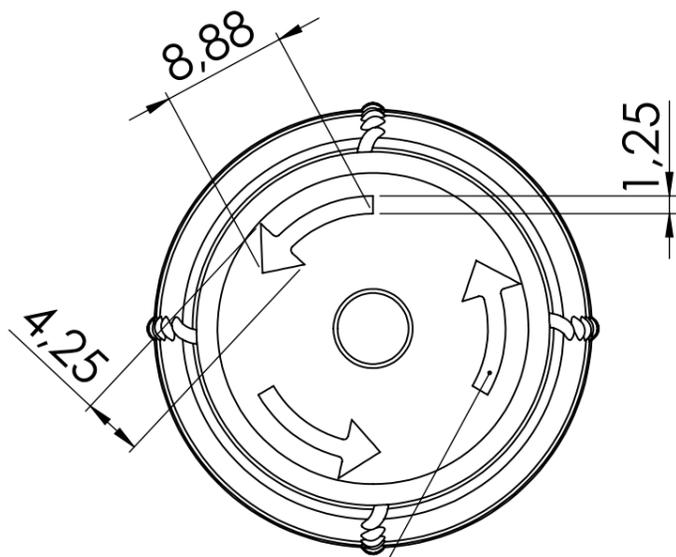
Altezza freccia in rilievo 0.20mm
